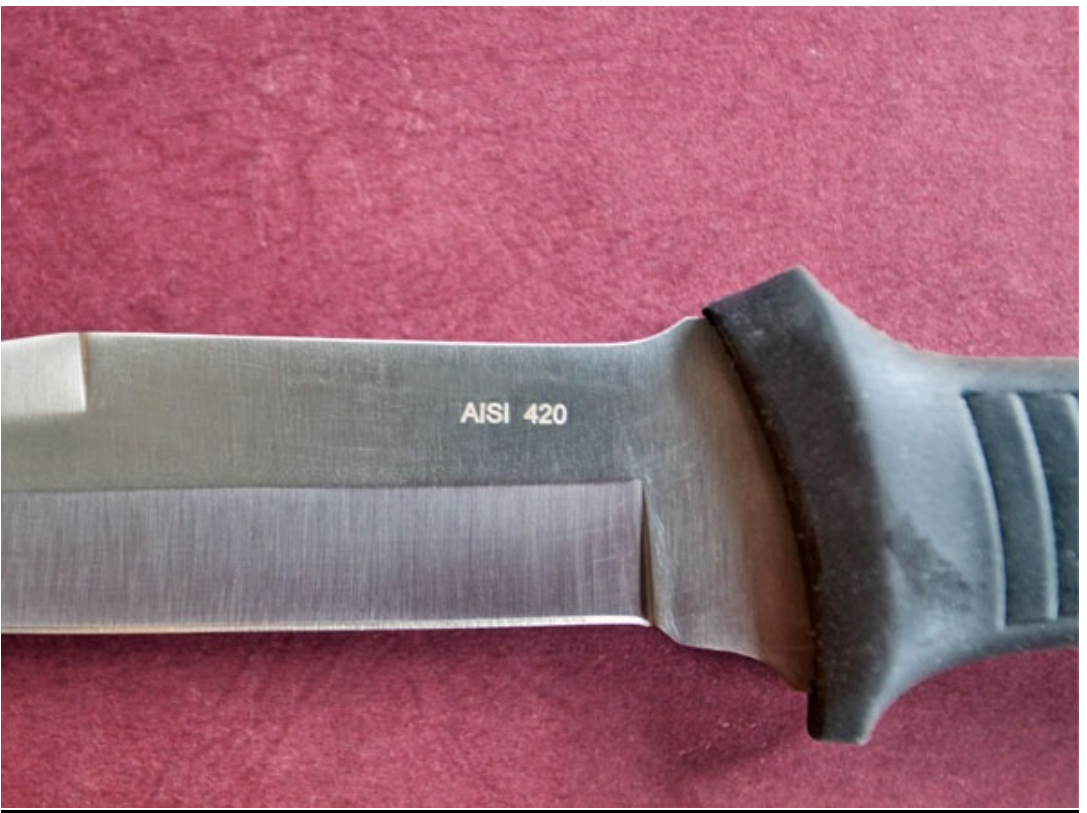
Der AISI 420 ist ein gängiger, hochlegierter Messerstahl. Seine DIN-Bezeichnung X40 Cr13 verrät das Legieru. Foto: Ekkehard Ophoven
