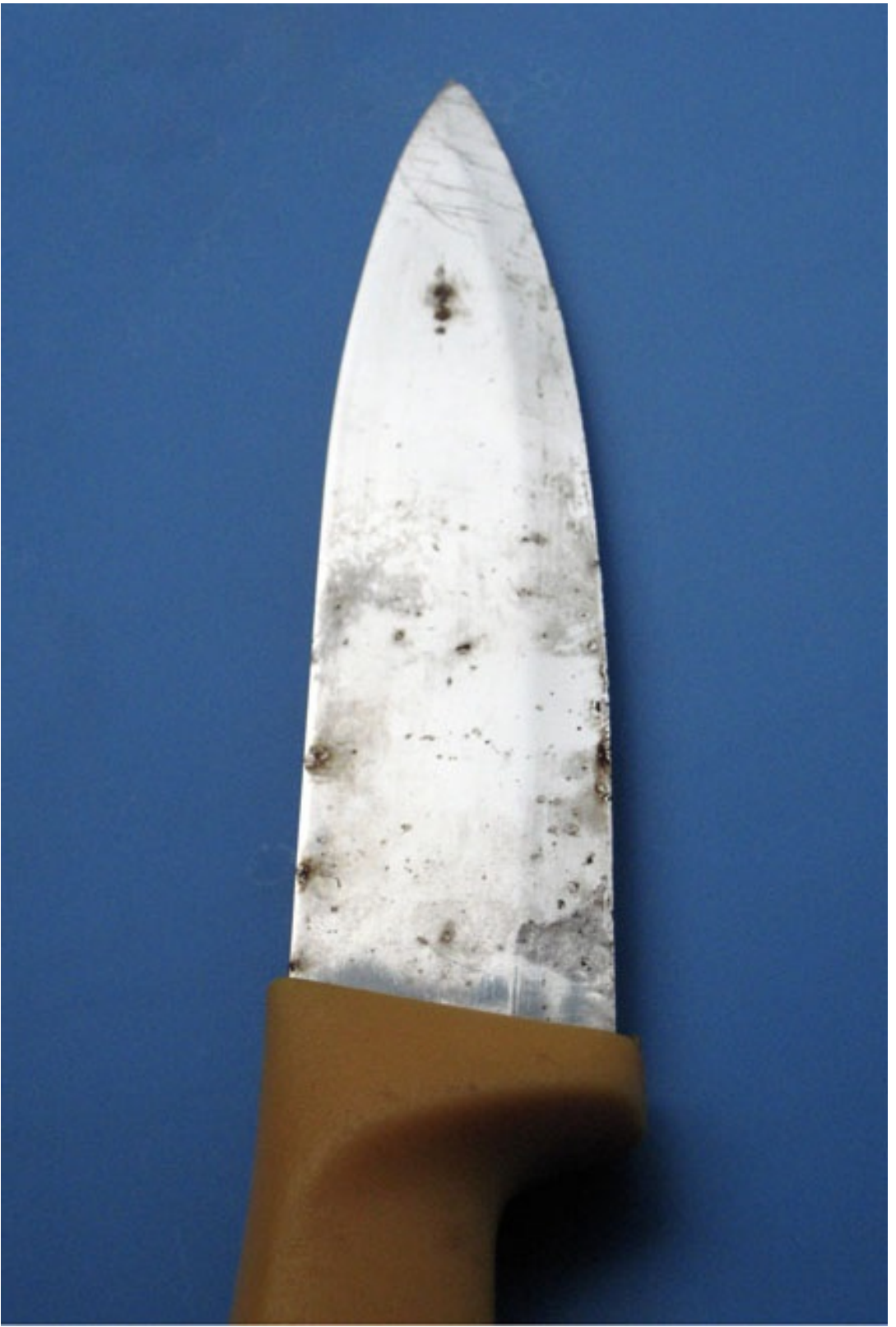
Korrosion kann auf chemischem und auf elektrochemischem Weg entstehen. Foto: Ernst Siebeneicher-Hellwig
