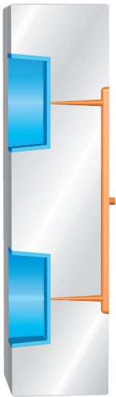
Bild 1.2 Dreiplatten-Kaltkanalwerkzeug mit sekundärem Angusskegel, der die Kavitäten mit Schmelze versorgt
