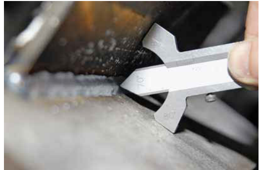
Abb. 4.2: Zur zerstörungsfreien Prüfung (ZfP) gehört auch das Messen einer Kehlnaht
